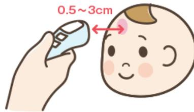
最近よくみかける非接触体温計。体から出る赤外線センサーが感知します。
